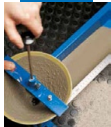
Испытание расширения в канавке согласно норме UNI 8997/89
