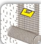
не менее 10 см. Сетка должна находиться в верхней трети клеевого раствора и покрываться слоем клея толщиной не менее 1 мм, а в месте перехлеста сеток не менее 0,5 мм. Неровности в базовом штукатурном слое можно зашкурить после высыхания раствора. Температура окружающей среды во время проведения работ должна быть не ниже +5 °C и не выше +30 °C. Толщина базового штукатурного слоя должна составлять не менее 4 мм и не более 8 мм.
